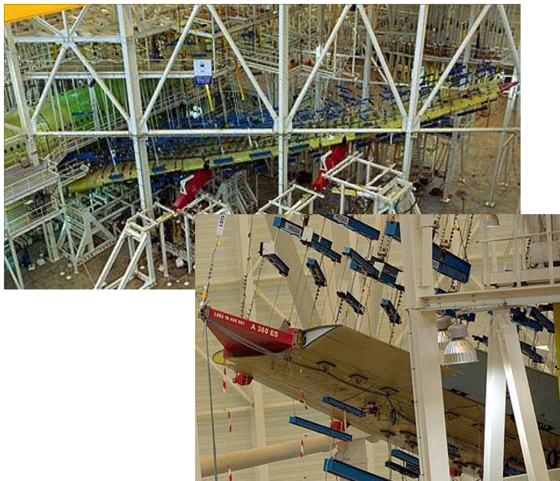
エアバス A380 全機静強度試験
