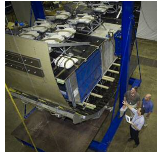
Boeing787のDrop test
