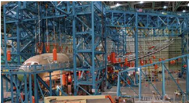
787 全機静強度試験
