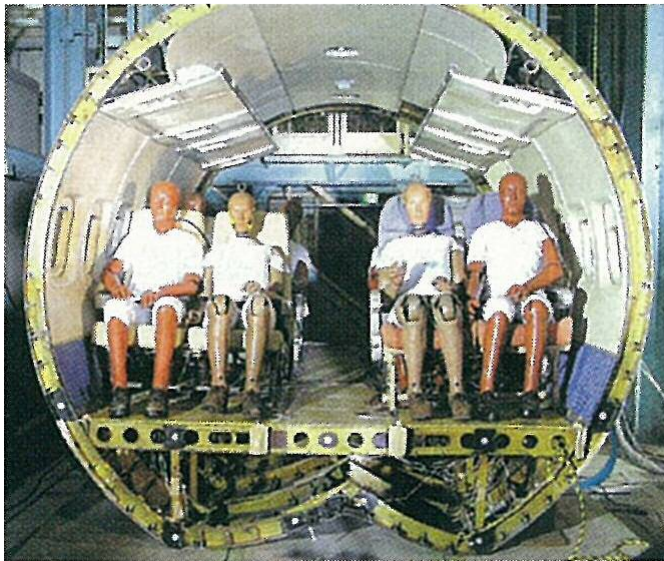
YS-11(金属構造)のDrop test
