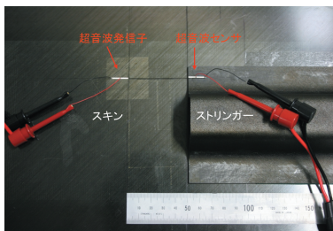
図1 CFRP 製スキン/ストリンガー構造部材に設置した圧電素子
